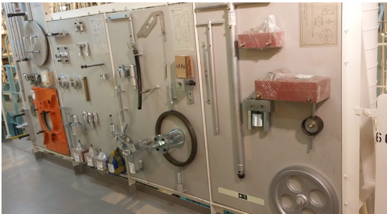
1.31. attēls. Galvenā dzinēja remontam paredzēto speciālo darbarīku komplekts
