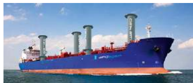
Četri saliekamie "Flettner" sistēmas rotoru uz tankkuģa.
