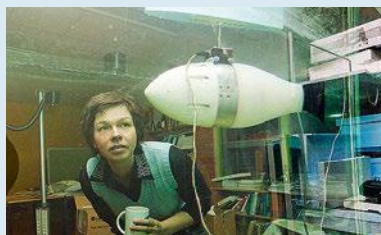
Igaunijā Silamē ostā darbojas Tallinas Tehnoloģiju universitātes (TTU) zinātnieku radīti sensori, kuru prototips ir zivis.
